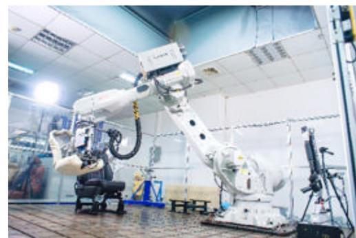
机器人正在进行座椅测试实验
